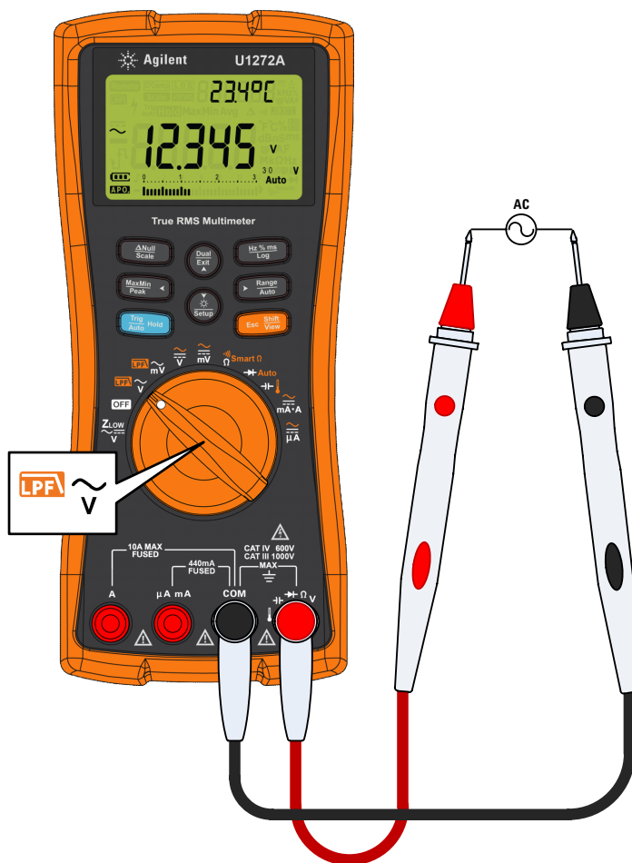
Figure 2-2 Mesure de tension CA
