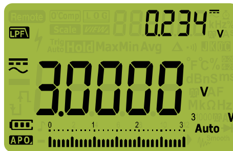
Figure 2-4 Couplage à courant continu pour les mesures de tension CA+CC
