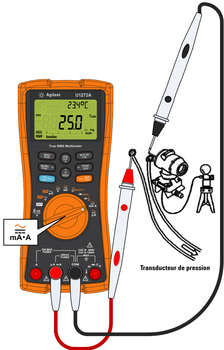
Figure 2-34 Mesure d'un courant CC à l'aide de l'échelle de pourcentage 4-20 mA
